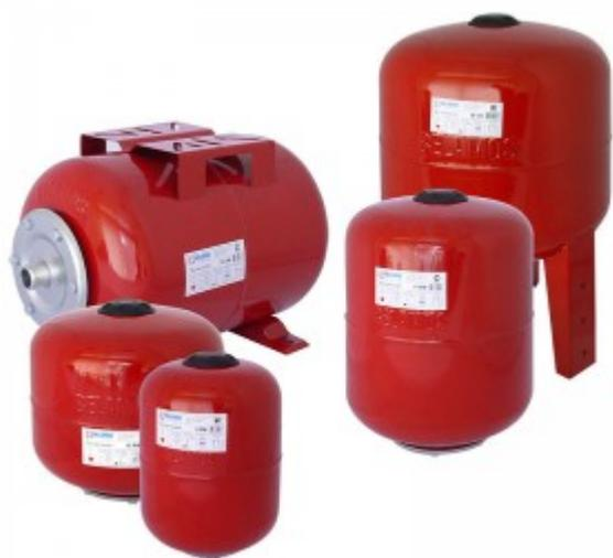
Расширительные баки мембранного типа предназначены для компенсации расширения теплоносителя при изменении температуры в системах отопления закрытого типа и поддержания в них рабочего давления. Устанавливаются в автономных системах отопления жилых, общественных зданиях, коттеджах и др.
